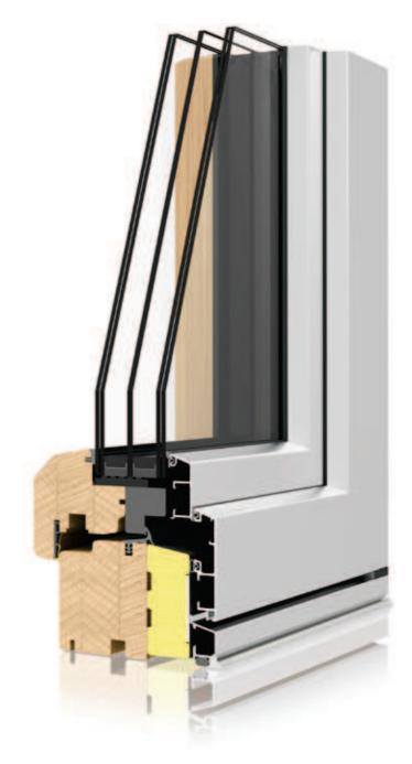
Nel sistema uni\_one Termoscudo, vengono inseriti fra il legno e l'alluminio, un telaio ed un anta in XPS che permettono di raggiungere valori di trasmittanza termica estremamente bassi.
